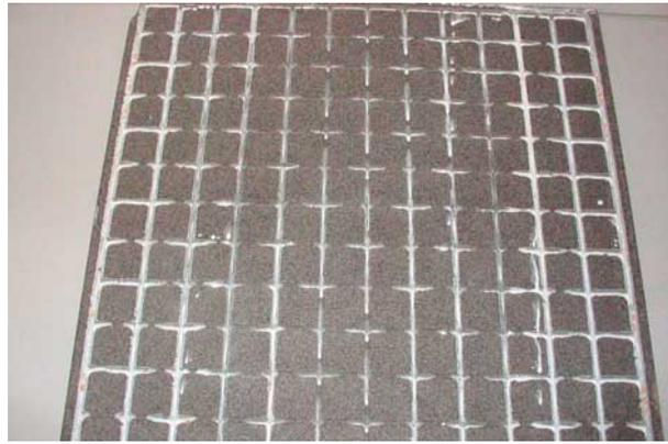
**Die Rückseite einer Platte hat sich beim Transport auf der Oberfläche einer anderen Platte „eingepägt“.**
